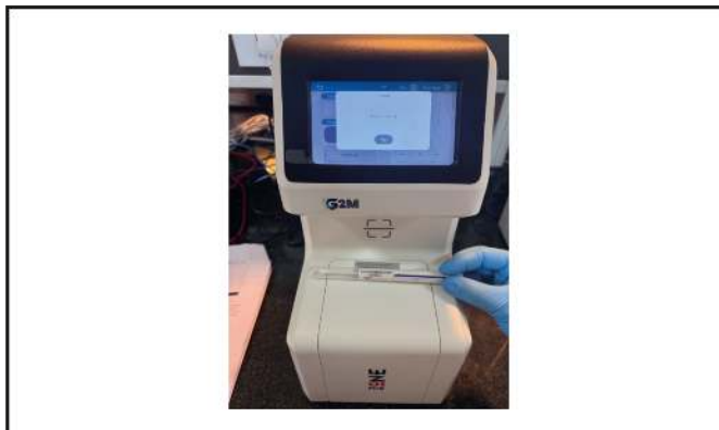
Obrázek 6: Funkce čtečky čárových kódů pro automatizované zadání čísla vzorku / ID pacienta
