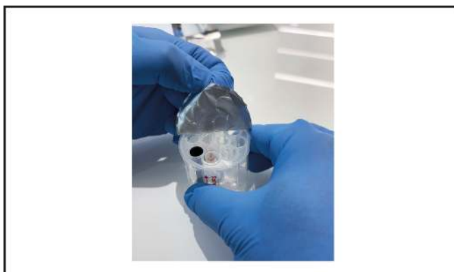
Obrázek 10: Odloupnutí fólie Cartridge-1
