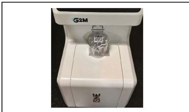
Obrázek 7: Skener QR kódu pro automatizovaný výběr programu
