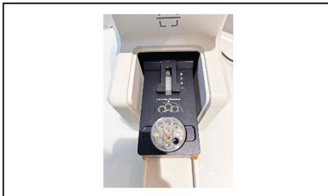
Obrázek 18: Správná orientace pro vložení Cartridge-2 do přístroje
