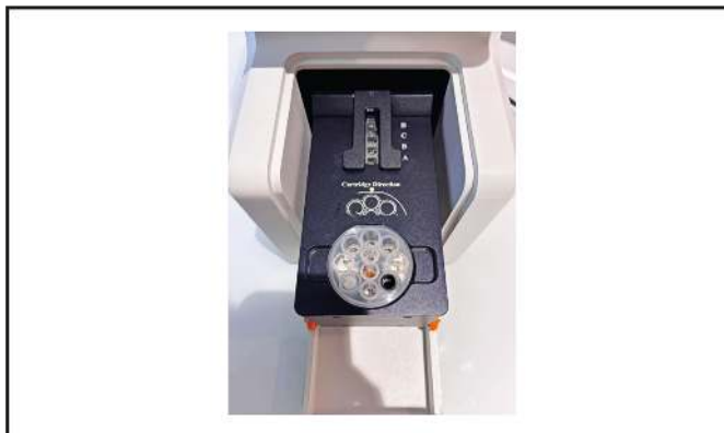
Obrázek 17: Správná orientace pro vložení Cartridge-1 do přístroje
