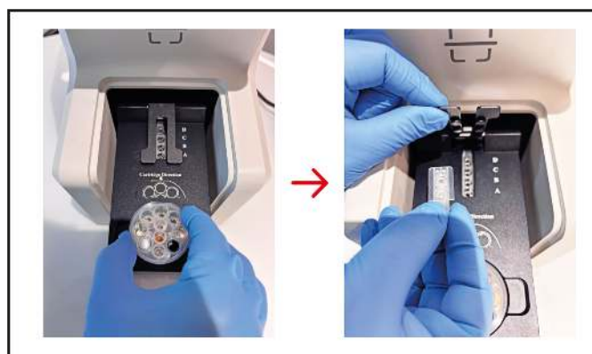
Obrázek 22: Otevření dvířek přístroje a vyjmutí cartridge
