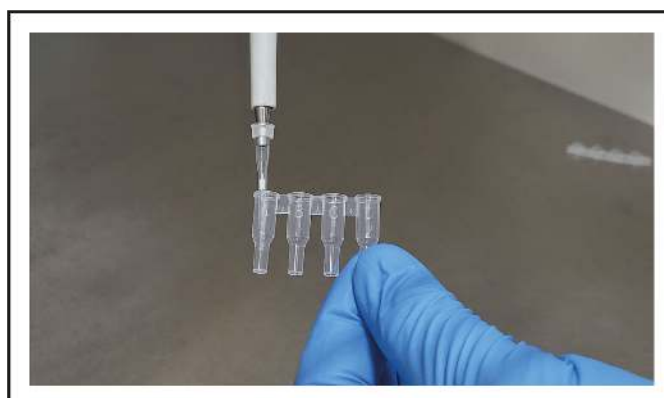
Obrázek 13: Rekonstituce lyofilizovaných činidel v Cartridge-2
