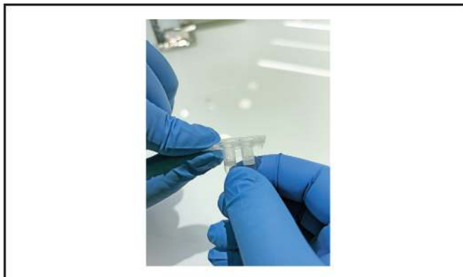
Obrázek 15: Správná orientace připevnění adaptéru na Cartridge-2
