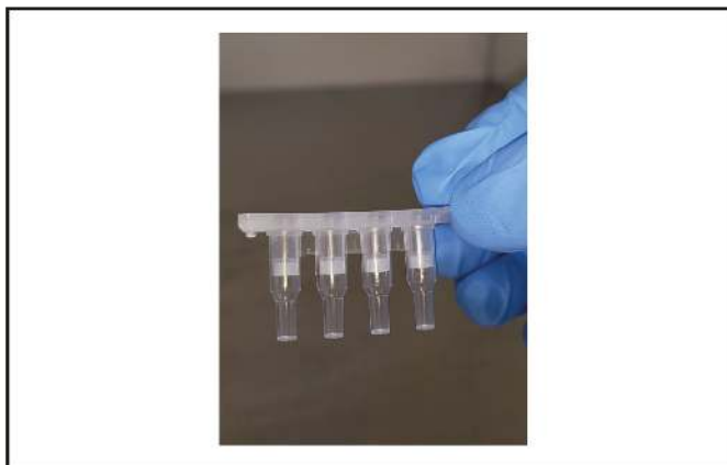
Obrázek 15: Správná orientace připevnění adaptéru na Cartridge-2
