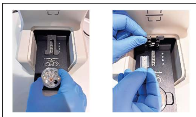
Obrázek 22: Otevření dvířek přístroje a vyjmutí cartridge
