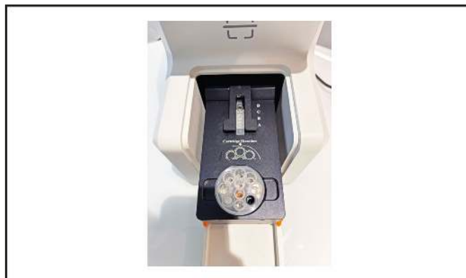
Obrázek 18: Správná orientace pro vložení Cartridge-2 do přístroje
