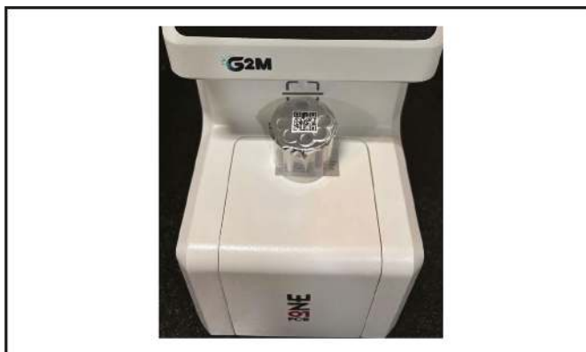
Obrázek 7: Skener QR kódu pro automatizovaný výběr programu
