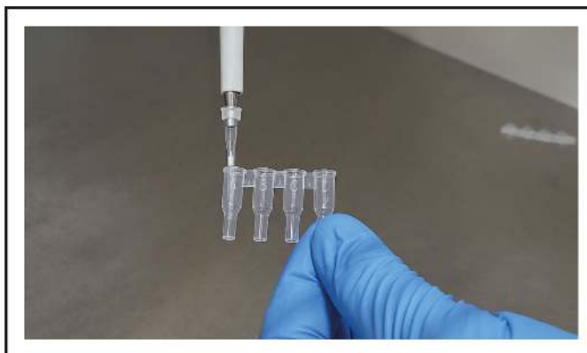
Obrázek 13: Rekonstituce lyofilizovaných činidel v Cartridge-2
