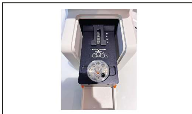
Obrázek 17: Správná orientace pro vložení Cartridge-1 do přístroje
