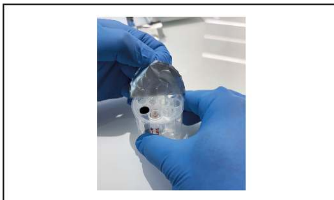
Obrázek 10: Odloupnutí fólie Cartridge-1
