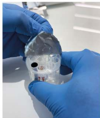
Obrázek 10: Odloupnutí fólie Cartridge-1
