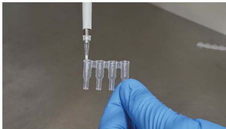
Obrázek 13: Rekonstituce lyofilizovaných činidel v Cartridge-2
