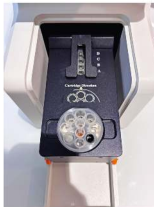
Obrázek 17: Správná orientace pro vložení Cartridge-1 do přístroje
