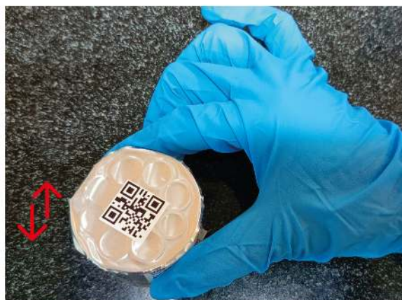
Obrázek 9: Poklepání Cartridge-1 na desce stolu
