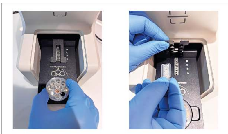
Obrázek 22: Otevření dvířek přístroje a vyjmutí cartridge
