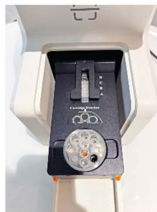
Obrázek 18: Správná orientace pro vložení Cartridge-2 do přístroje
