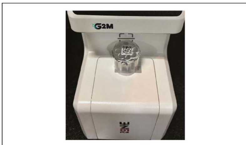
Obrázek 7: Skener QR kódu pro automatizovaný výběr programu
