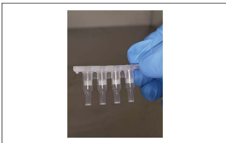
Obrázek 15: Správná orientace připevnění adaptéru na Cartridge-2
