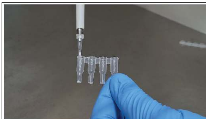
Obrázek 13: Rekonstituce lyofilizovaných činidel v Cartridge-2
