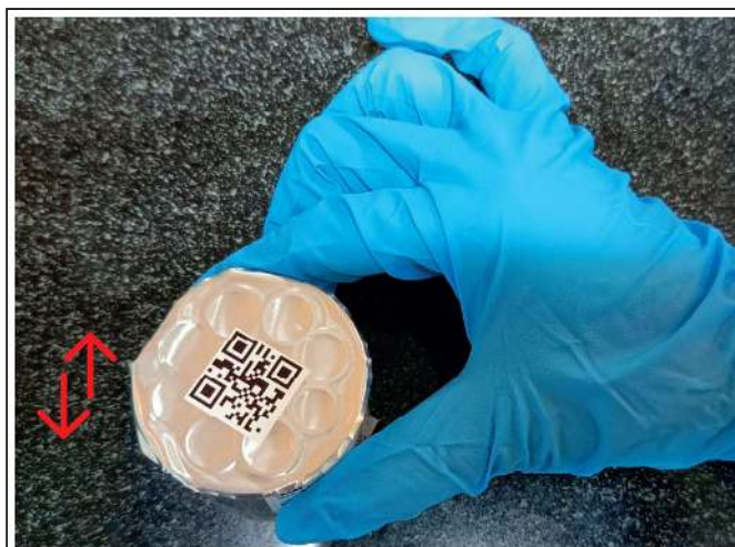
Obrázek 9: Poklepání Cartridge-1 na desce stolu
