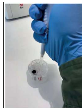
Obrázek 11: Přidání vzorku do jamky „Sample“ Cartridge-1
