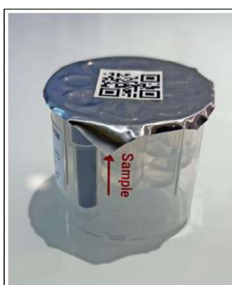
Obrázek 11: Přidání vzorku do jamky „Sample“ Cartridge-1
