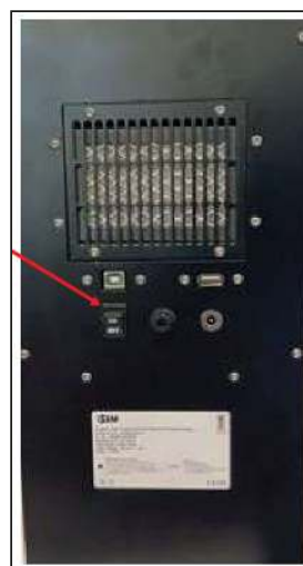
Obrázek 28: Přepnutí vypínače do polohy „off“ na zadní straně přístroje
