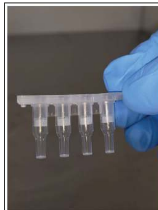
Obrázek 15: Správná orientace připevnění adaptéru na Cartridge-2
