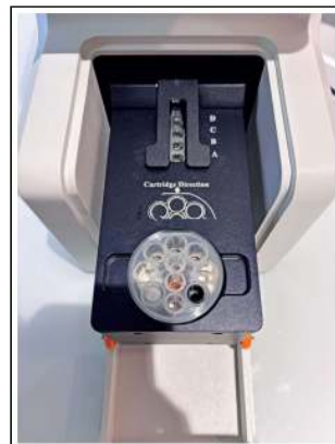
Obrázek 17: Správná orientace pro vložení Cartridge-1 do přístroje
