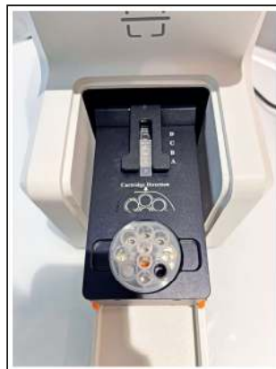
Obrázek 18: Správná orientace pro vložení Cartridge-2 do přístroje
