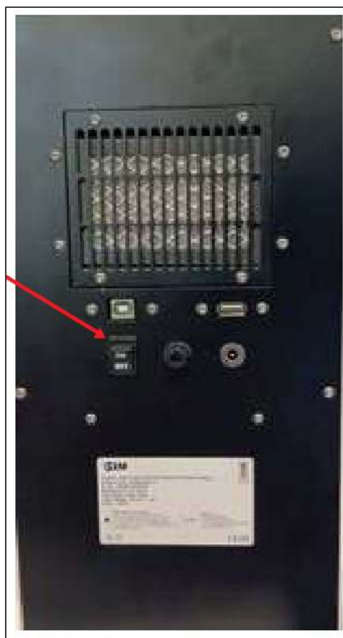
Obrázek 1: Přepněte vypínač do polohy „ON“ na zadní straně přístroje
