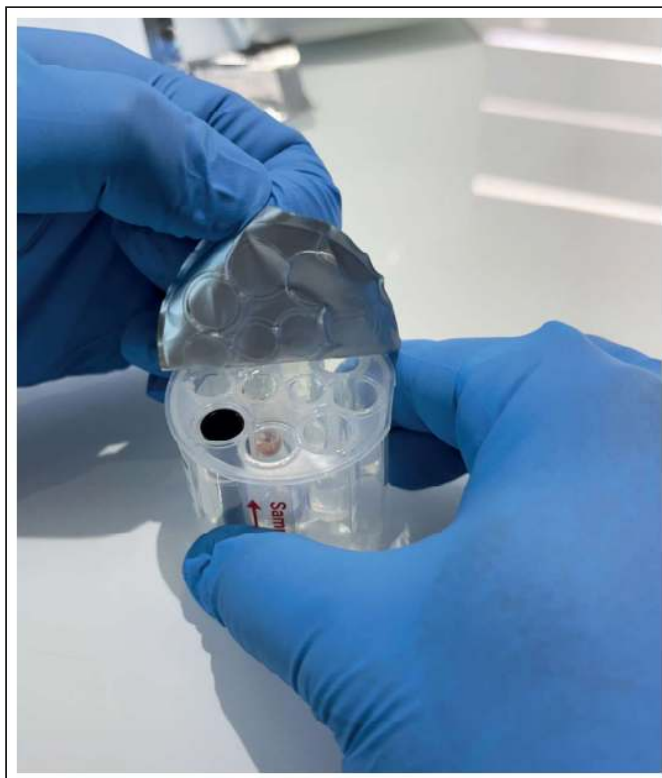
Obrázek 10: Odloupnutí fólie Cartridge-1
