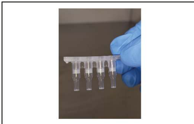
Obrázek 15: Správná orientace připevnění adaptéru na Cartridge-2
