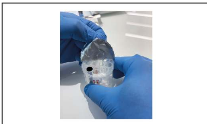
Obrázek 10: Odloupnutí fólie Cartridge-1
