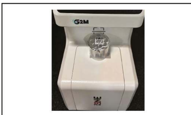
Obrázek 7: Skener QR kódu pro automatizovaný výběr programu
