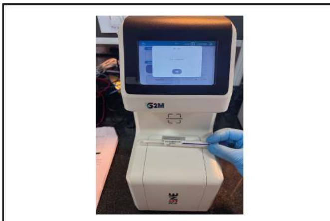
Obrázek 6: Funkce čtečky čárových kódů pro automatizované zadání čísla vzorku / ID pacienta
