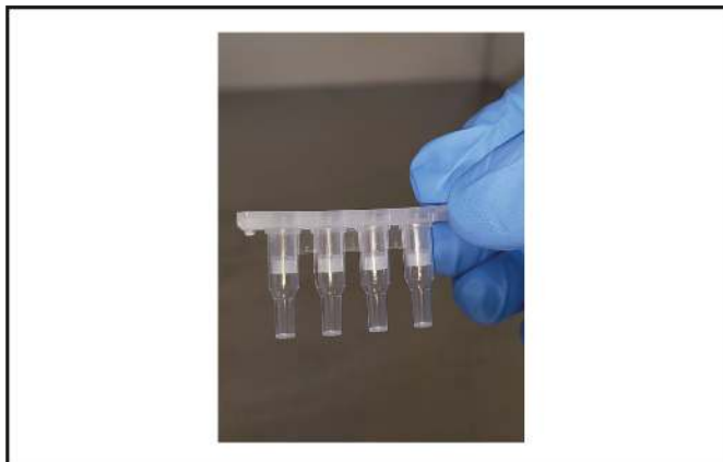
Obrázek 15: Správná orientace připevnění adaptéru na Cartridge-2
