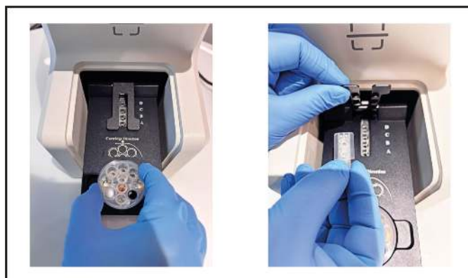
Obrázek 22: Otevření dvířek přístroje a vyjmutí cartridge
