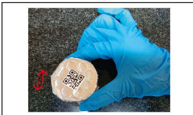
Obrázek 9: Poklepání Cartridge-1 na desce stolu
