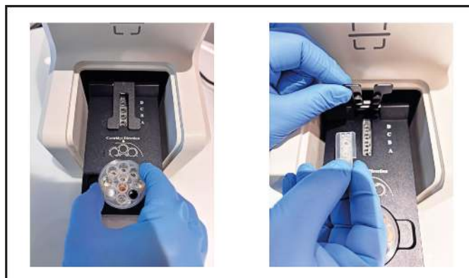
Obrázek 22: Otevření dvířek přístroje a vyjmutí cartridge
