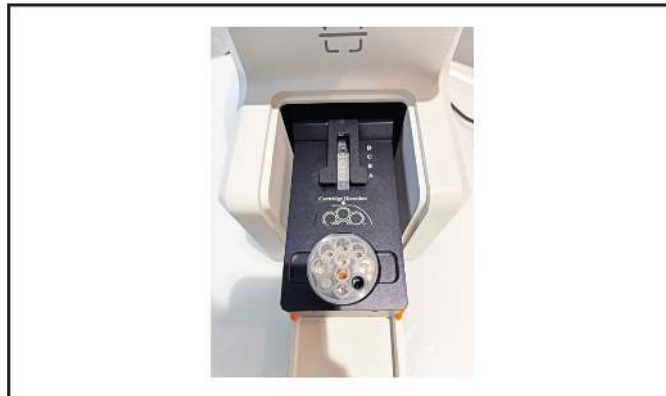
Obrázek 18: Správná orientace pro vložení Cartridge-2 do přístroje
