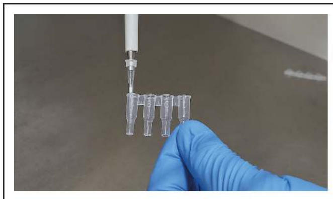
Obrázek 13: Rekonstituce lyofilizovaných činidel v Cartridge-2
