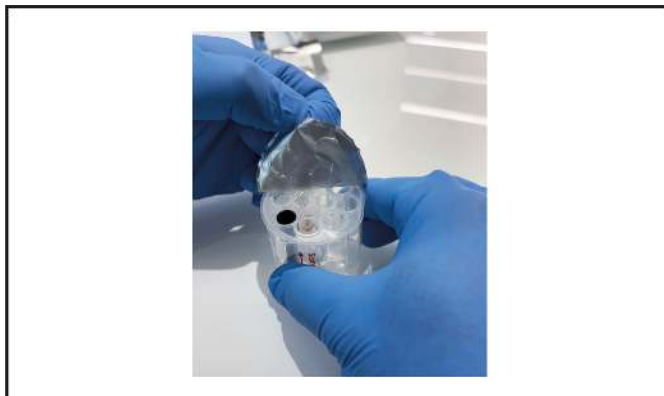
Obrázek 10: Odloupnutí fólie Cartridge-1
