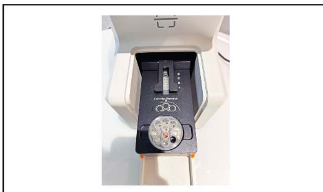
Obrázek 18: Správná orientace pro vložení Cartridge-2 do přístroje
