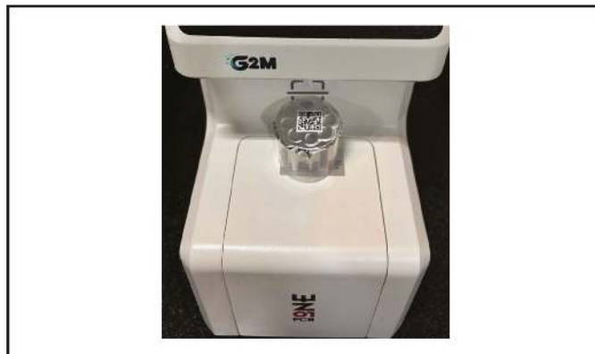
Obrázek 7: Skener QR kódu pro automatizovaný výběr programu
