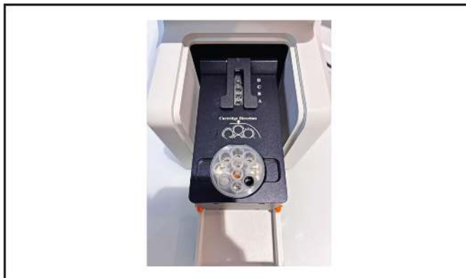
Obrázek 17: Správná orientace pro vložení Cartridge-1 do přístroje
