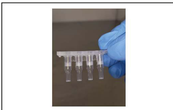
Obrázek 15: Správná orientace připevnění adaptéru na Cartridge-2
