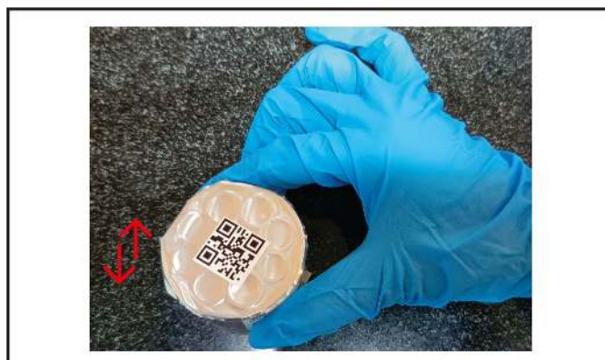
Obrázek 9: Poklepání Cartridge-1 na desce stolu
