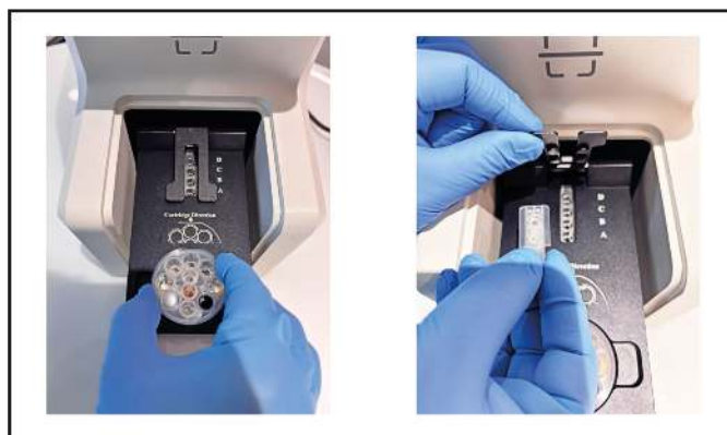
Obrázek 22: Otevření dvířek přístroje a vyjmutí cartridge
