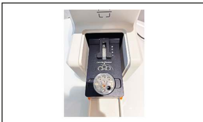
Obrázek 18: Správná orientace pro vložení Cartridge-2 do přístroje
