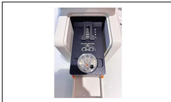
Obrázek 17: Správná orientace pro vložení Cartridge-1 do přístroje
