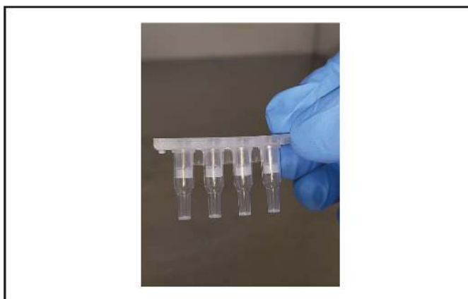
Obrázek 15: Správná orientace připevnění adaptéru na Cartridge-2
