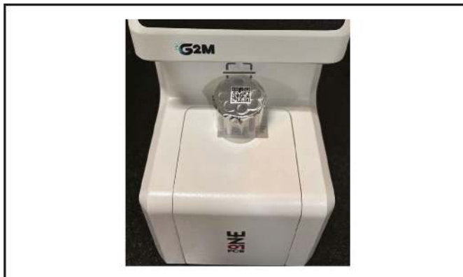
Obrázek 7: Skener QR kódu pro automatizovaný výběr programu
