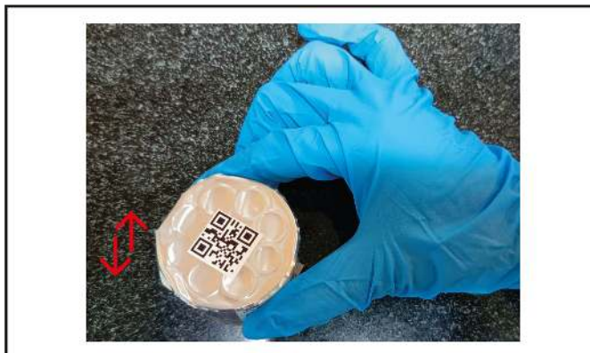
Obrázek 9: Poklepání Cartridge-1 na desce stolu
