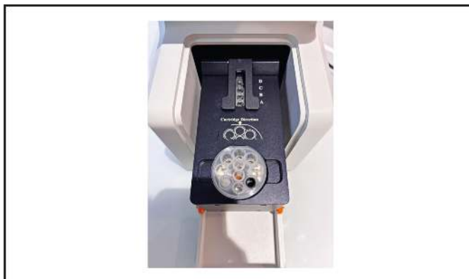
Obrázek 17: Správná orientace pro vložení Cartridge-1 do přístroje
