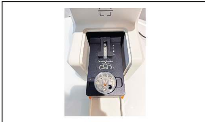
Obrázek 18: Správná orientace pro vložení Cartridge-2 do přístroje
