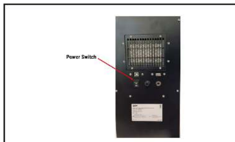
Obrázek 1: Přepněte vypínač do polohy „ON“ na zadní straně přístroje
