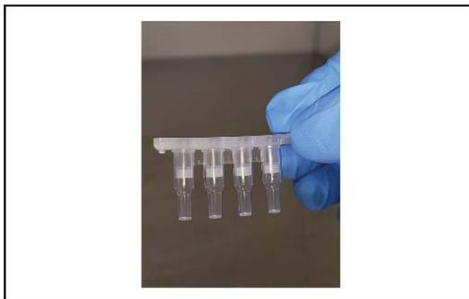
Obrázek 15: Správná orientace připevnění adaptéru na Cartridge-2
