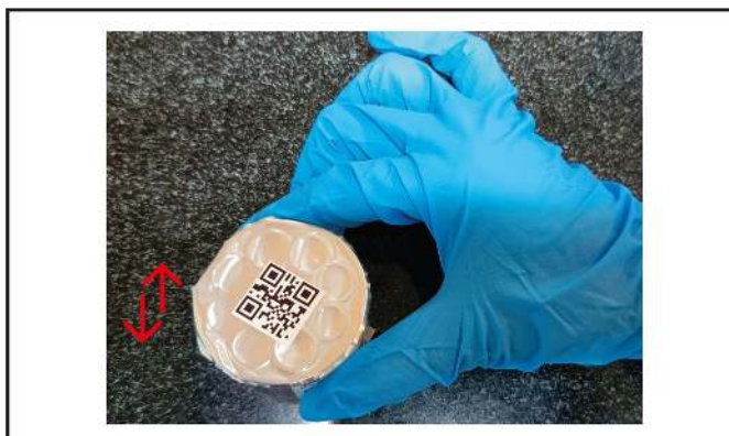
Obrázek 9: Poklepání Cartridge-1 na desce stolu
