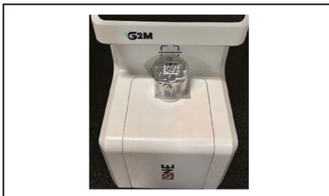
Obrázek 7: Skener QR kódu pro automatizovaný výběr programu
