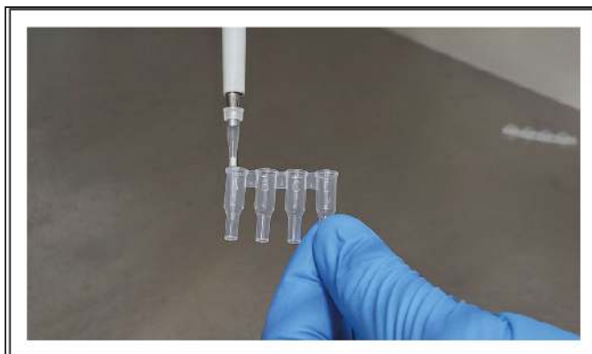
Obrázek 13: Rekonstituce lyofilizovaných činidel v Cartridge-2
