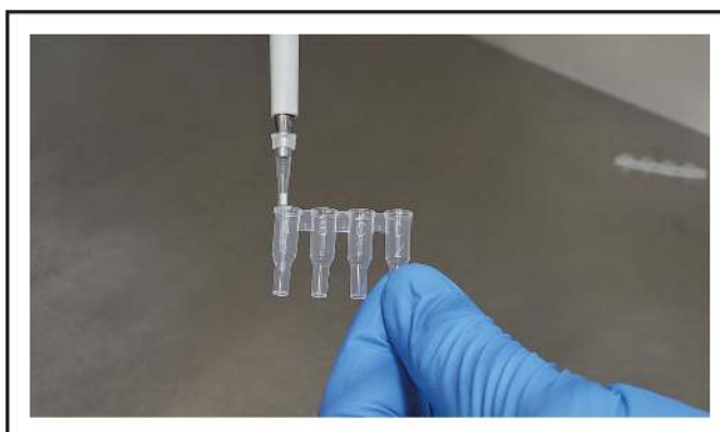
Obrázek 13: Rekonstituce lyofilizovaných činidel v Cartridge-2
