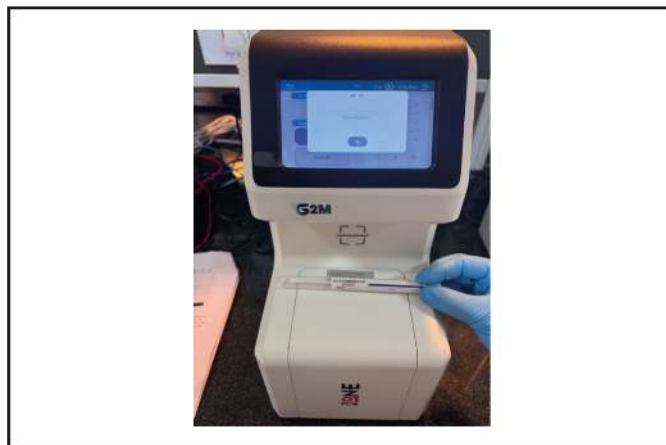
Obrázek 4: Výběr možnosti „Run“ v hlavním rozhraní přístroje
