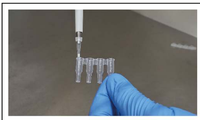
Obrázek 13: Rekonstituce lyofilizovaných činidel v Cartridge-2
