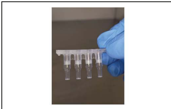
Obrázek 15: Správná orientace připevnění adaptéru na Cartridge-2
