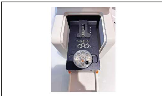
Obrázek 17: Správná orientace pro vložení Cartridge-1 do přístroje
