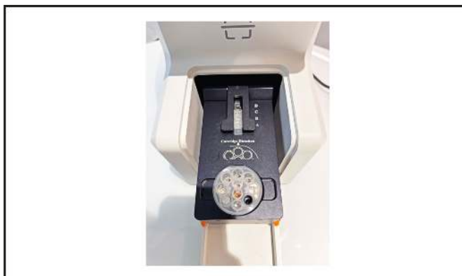
Obrázek 18: Správná orientace pro vložení Cartridge-2 do přístroje
