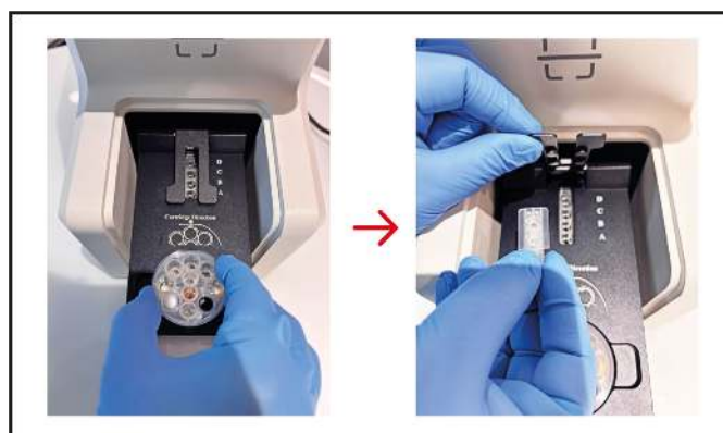
Obrázek 22: Otevření dvířek přístroje a vyjmutí cartridge
