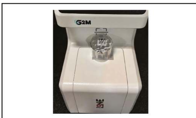
Obrázek 7: Skener QR kódu pro automatizovaný výběr programu
